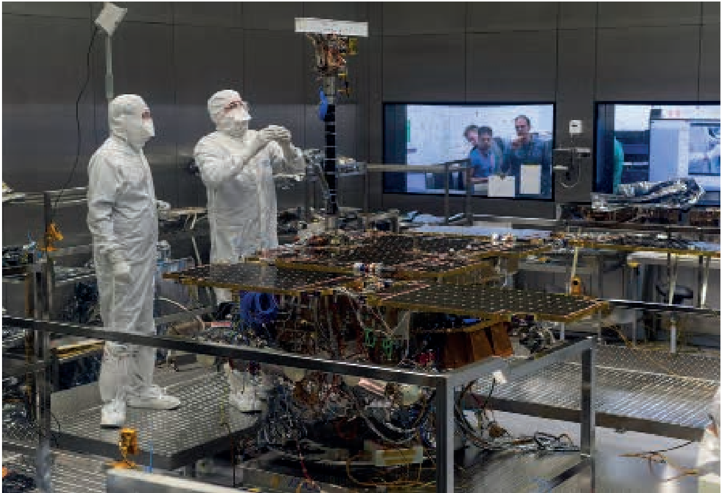
De panoramische camera wordt bevestigd op Rosalind Franklin, de marsrover die deel uitmaakt van het Europese ExoMars programma om het oppervlak van de rode planeet te onderzoeken naar organisch materiaal. ©ESA.
