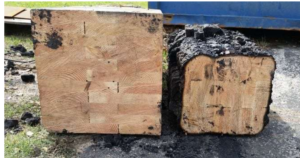
Charring rate hangt af van warmteflux (~1mm per minuut)
